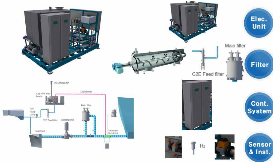
[그림 39] 전기분해방식(간접식)의 대표적인 Component
