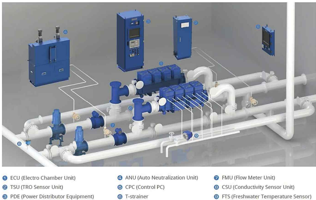
[그림 5] 직접식 전기분해방식의 시스템구성
